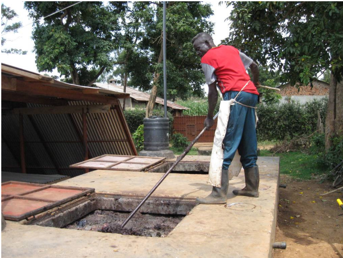
Ein Bewohner von Bungoma rührt die Schlachtabfälle im Hydrolysetank.
