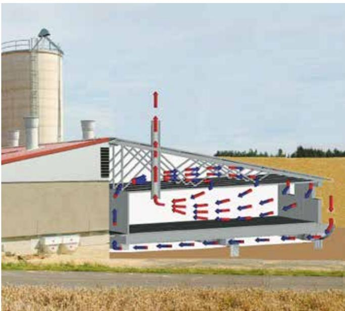
Abbildung 9: Unterflur Zuluftkühlung – OPTI Stall Fa. Aco Funki (Quelle: DLG Merkblatt 5520F)
